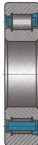
Тип 12000 с одним бортом на наружном кольце
