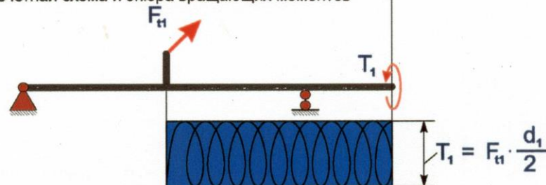
Расчетная схема и эпюра вращающих моментов
