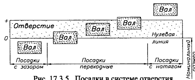
Рис. 17.3.5. Посадки в системе отверстия
