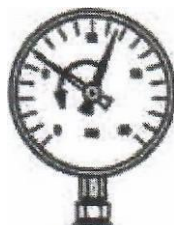
Рисунок 2.15— Обнуление максимального давления
