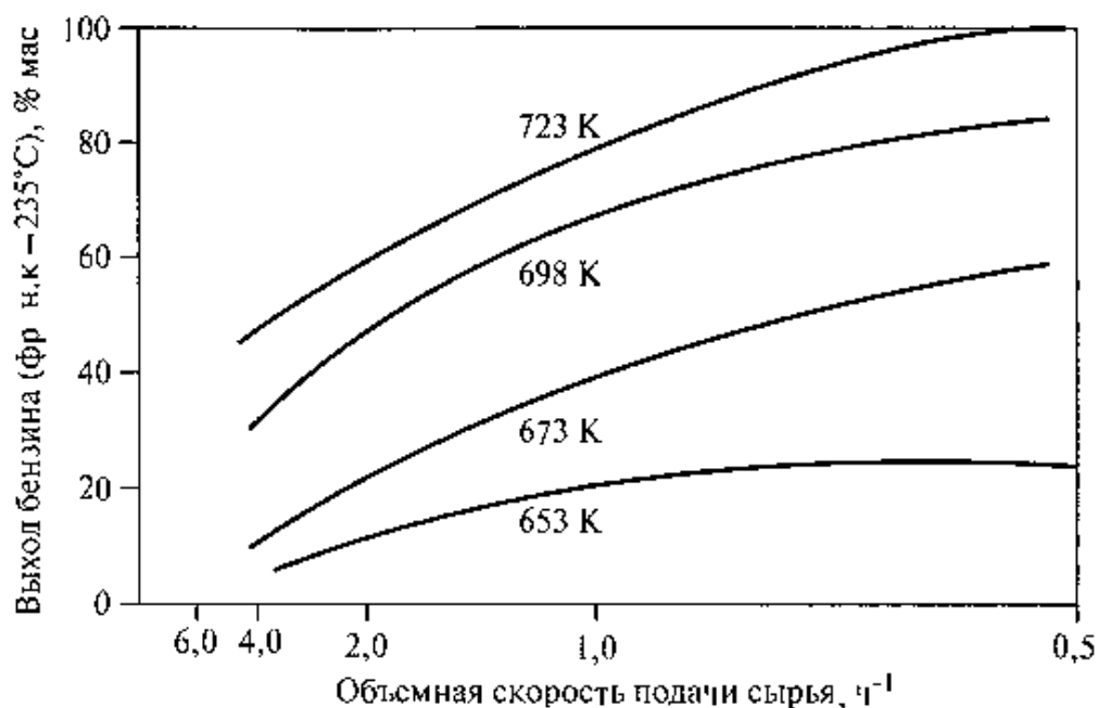
Рисунок 2.3.2 - Зависимость выхода бензина от объёмной скорости при различных температурах
