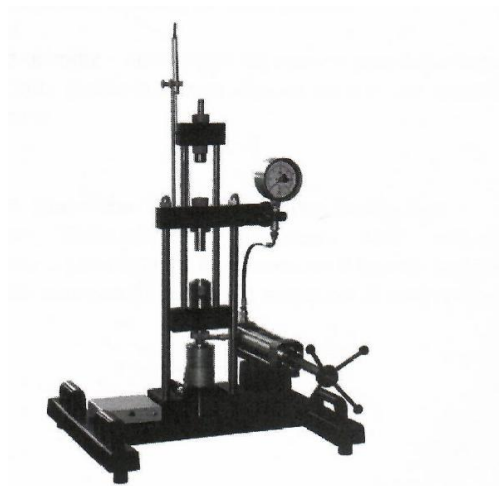
Рисунок 5.5 – Универсальная машина для исследования свойств материала УИМ – 2 ПС
