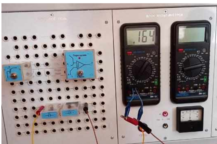
Рисунок 2 – Измерение емкости конденсаторов
