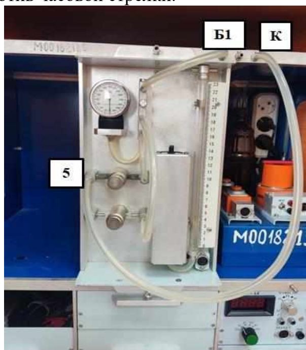
Рисунок 4 – Подключение компрессора и баллона Б1 ( V_1=1\text{л} )
