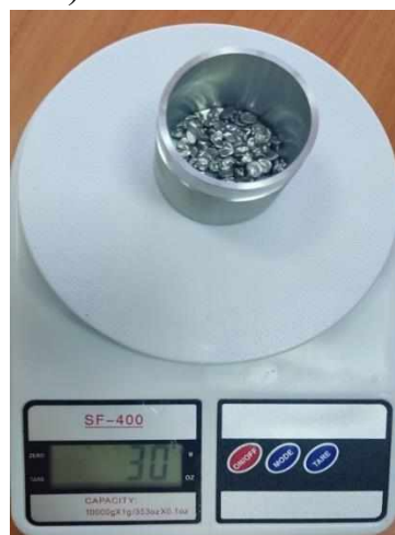
Рисунок 5б – Сплав Розе массой 30 г
