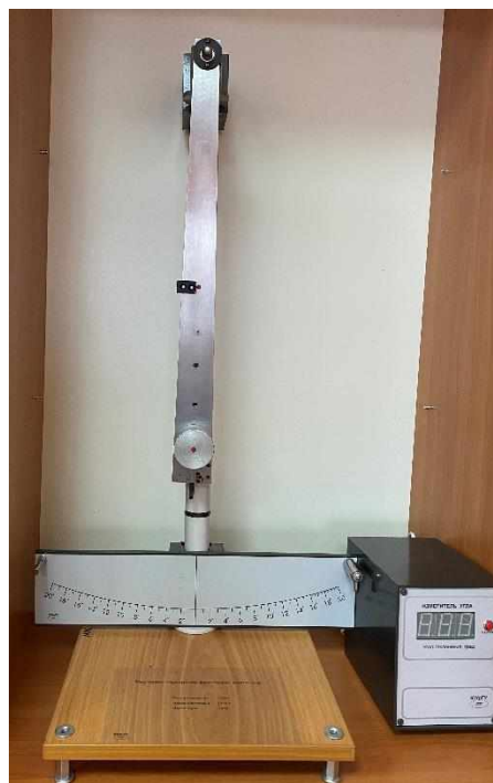
Рисунок 1 – Установка для проверки закона сохранения момента импульса
