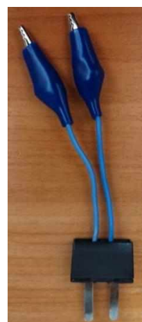
Рисунок 2 б – Специальный переходник с «крокодилами»
