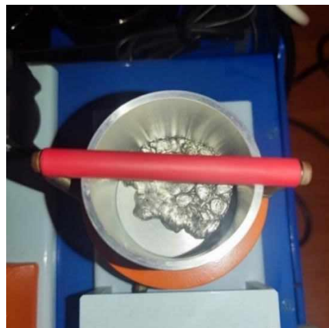
Рисунок 6 б – Сплав Розе после выполнения эксперимента
