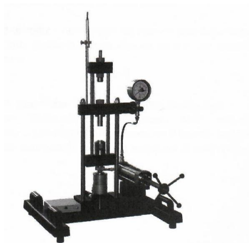
Рисунок 1 – Универсальная машина для исследования свойств материала УИМ – 2 ПС
