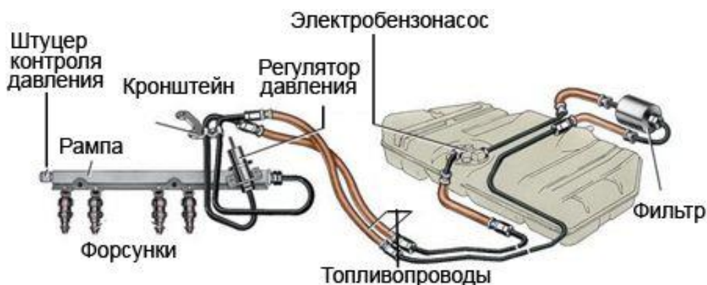
Рис.3.4 Система питания топливом инжекторного двигателя
