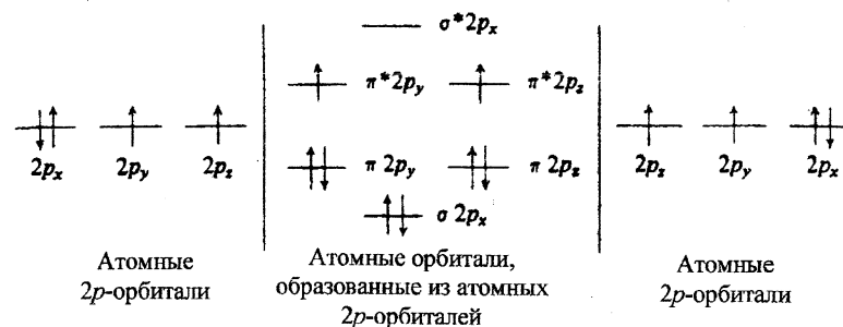
Рис. 2. Электронная структура молекулы кислорода
