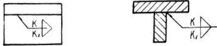
Рис. А.9 – Условное изображение таврового двустороннего шва
