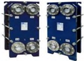
Теплообменник E8-AW100 Среда: Паста/Вода Тепловая нагрузка: 34.4-43.5/40-54°C Расход: 6.95 м³/ч / 88.1 т/ч Мощность: 4010 кВт или в другой системе измерения 3439 МВт/ч Пластины: 0.5 мм / AISI 316L
