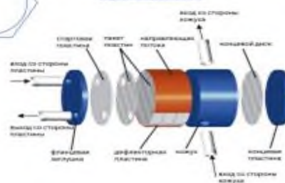
Схема кожухопластинчатого сварного теплообменника
