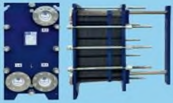
Теплообменник E8-5100 Среда: Этанол/метанол/40%/Микроэмульсия 1-ступенная. Тепловая нагрузка: 50-56/170-82°C Расход: 62.8 м³/ч / 613.3 т/ч Мощность: 307 кВт или в другой системе измерения 750 МВт/ч 2-ступенная. Тепловая нагрузка: 14-16/40-54, 5-45, 17°C Расход: 31.45 м³/ч / 613.3 т/ч Мощность: 291 кВт или в другой системе измерения 83 МВт/ч Пластины: 0.7 мм / Титан
