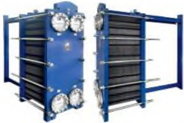
Теплообменник E8-3200 Среда: Товарная нефть/Газолиготная смесь Тепловая нагрузка: 40-57/12-10°C Расход: 47.68 м³/ч / 168.0 т/ч Мощность: 930 кВт или в другой системе измерения 55/7 МВт/ч Пластины: 0.7 мм / Титан
