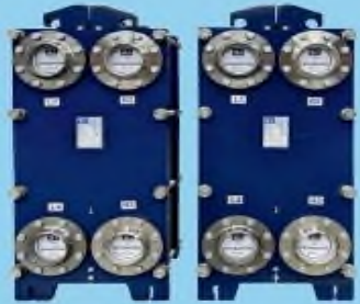
Теплообменник E8-AW100 Среда: Вода/Вода (системная наладка/чистая вода) Тепловая нагрузка: 80-140/16-10°C Расход: 5.5-14 м³/ч / 12.3-11 т/ч Мощность: 2500 кВт или в другой системе измерения 1150 МВт/ч Пластины: 0.5 мм / Титан
