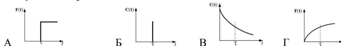
**8. В диффузионной модели характер отклика при ступенчатом возмущении графически выглядит следующим образом**
