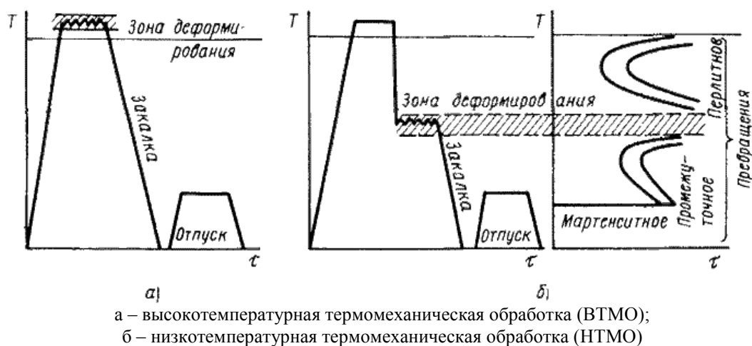
Рис. 8.2. Схема режимов термомеханической обработки стали
