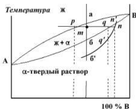
Рис. 6. Диаграмма состояния сплавов с полной растворимостью компонентов
